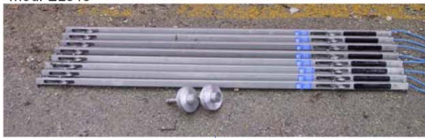
Inclinometro fisso di profondità mod. EL345
