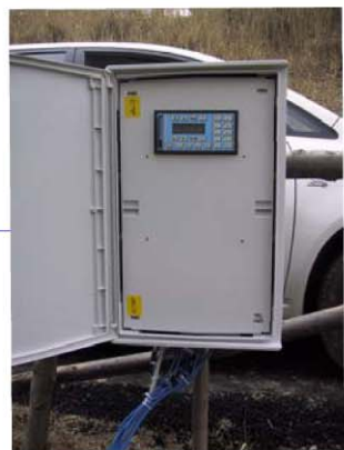
Unità di acquisizione dati mod. EL6200
